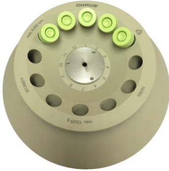
Figura 13-1 INCORRECTO Figura 13-2 CORRECTO (6 tubos)
