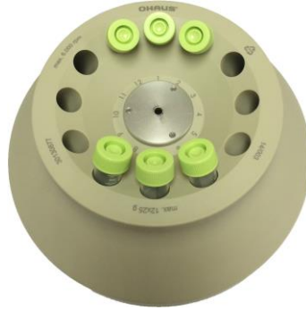
Figura 13-1 INCORRECTO Figura 13-2 CORRECTO (6 tubos)
